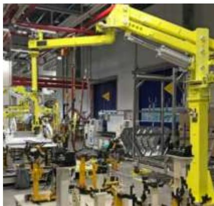
В основе конструкции манипулятора лежит наклонное звено с параллельной кинематикой (схема «пантограф»), которое выполняет перемещение в вертикальной плоскости посредством пневматического цилиндра с системой специализированных прецизионных регуляторов давления. В зависимости от управляющего сигнала, получаемого от рукояти управления, регуляторы изменяют давление в рабочей полости цилиндра, тем самым меняя его усилие, необходимое для уравновешивания полезной нагрузки и перемещения.
