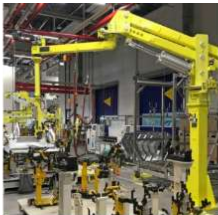
Пример реализации манипулятора г/п 550 кг для загрузки сварной подбортки автомобильного кузова на сварочный индуктор (завод «Мерседес»)
